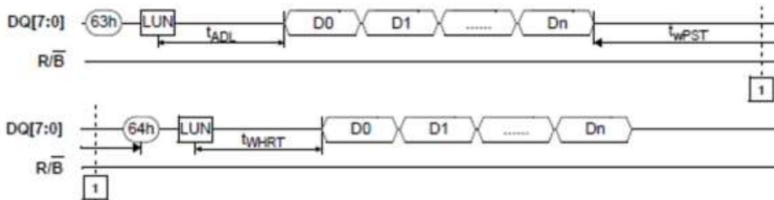
Figure 5-52 Write DQ Training (Tx side)
