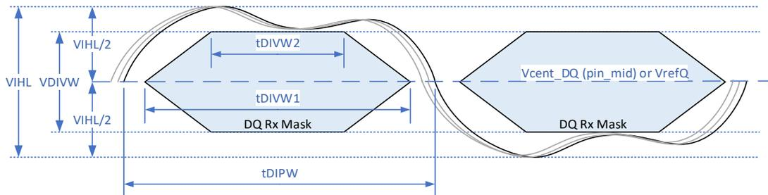
**Figure 4-22 NV-DDR3/NV-LPDDR4 DQ Rx Mask and VIH Definition**
